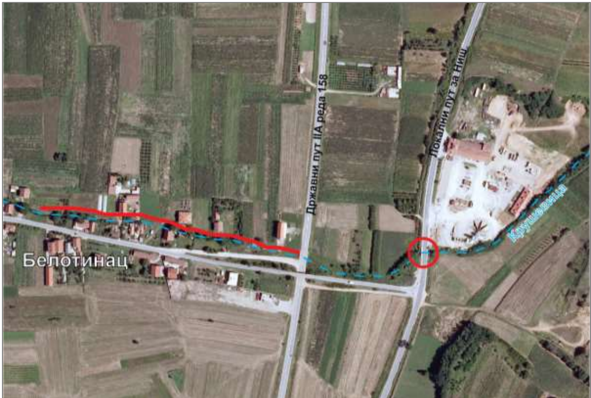
Критичне тачке изливања Крушевице (пропуст на локалном путу и деоница на улазу у Белотинац)
